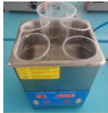
图 6 样品在超声波中进行清洗的状态图
